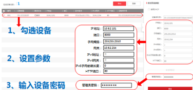
图 6-1 修改设备 IP 地址
